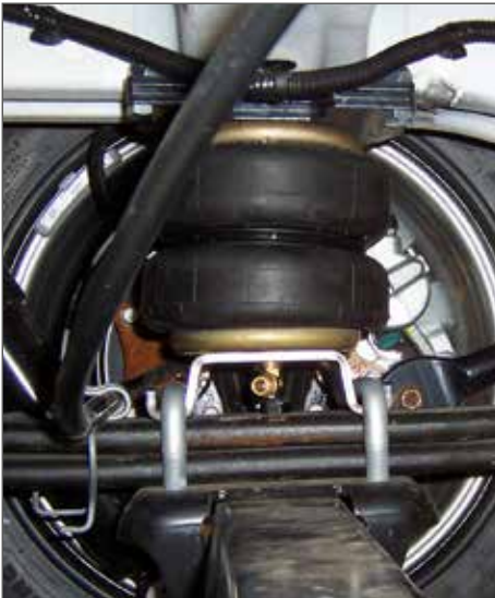
▲ Abb. 17.1 6" Balg komplett eingebaut.
