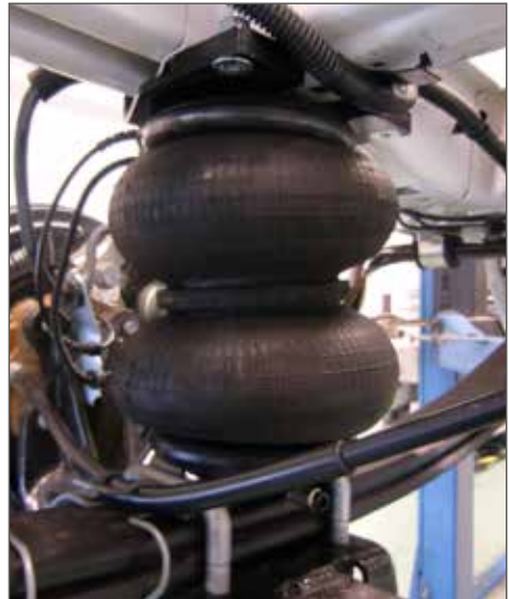
▲ Abb. 17.2 8" Balg komplett eingebaut
